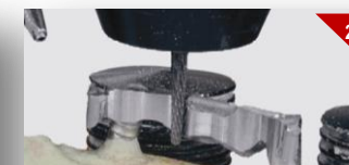
2 Finitura della barra fusa con l'isoparallelometro
