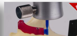
1 Posizionamento della patrice su una barra su impianti
